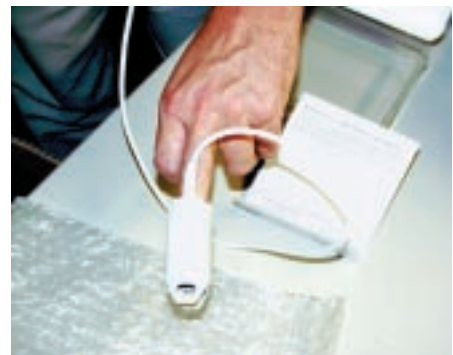
9 Датчик измеряет поглощение света тканями пальца, чтобы определить, насколько гемоглобин насыщен кислородом
